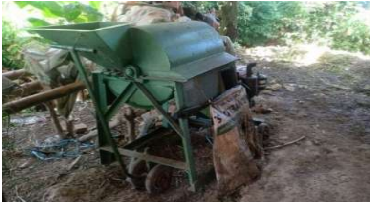
Gambar 2. Mesin Pencacah ( Chopper ) Kelompok Tani Harapan Sejahtera Aie Pacah
