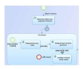
Gambar 4. Potongan BPMN produksi asam glutamat
